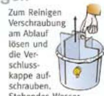
Zum Reinigen Verschraubung am Ablauf lösen und die Verschlusskappe aufschrauben. Stehendes Wasser abschöpfen und den Einsatz herausziehen.
